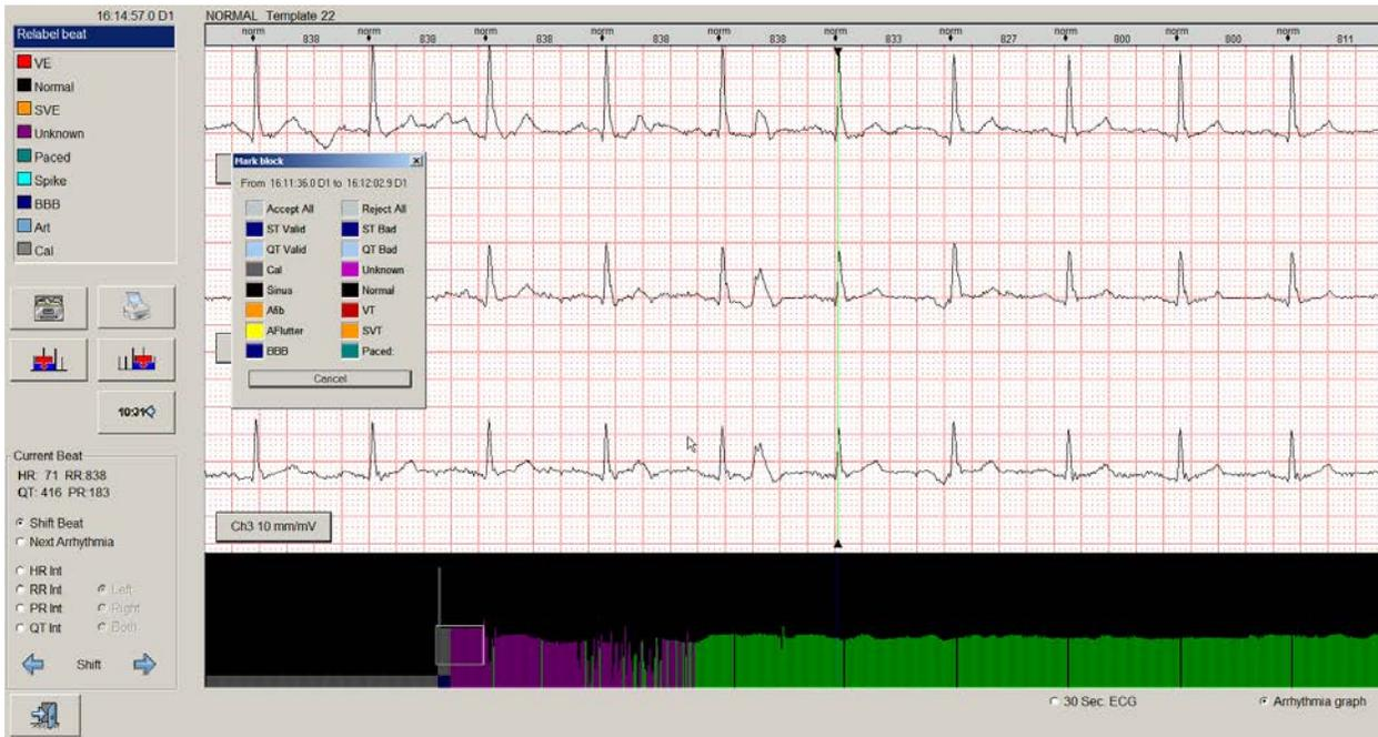
Ci-dessus, l'élastique a été dessiné sur le graphique de l'arythmie pour sélectionner quelques battements non identifiés pour un ré-étiquetage comme impulsion d'étalonnage.
