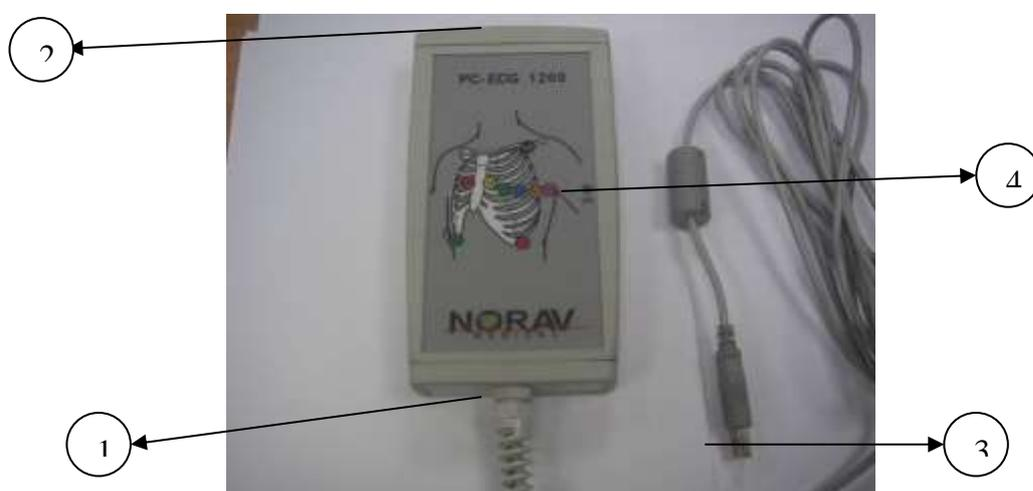
Figure 5: PC-ECG 1200HR (avec câble USB intégré)
